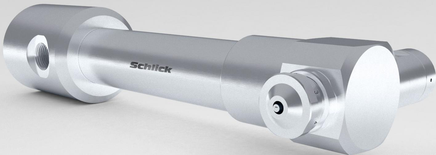
940系列喷嘴雾化角度为 $10^{\circ} - 40^{\circ}$ ，生产过程中，雾化一致性非常好，另外940系列喷嘴为模块化产品，如有损坏，各部件都可以单独更换，也可通过更换部分部件改造成另外一种型号，并且雾化效果也能得到保证。喷嘴和喷杆就组成了制药行业专用喷枪，喷杆材质一般为耐酸不锈钢，长度按客户需求制作，连接精准可靠。
