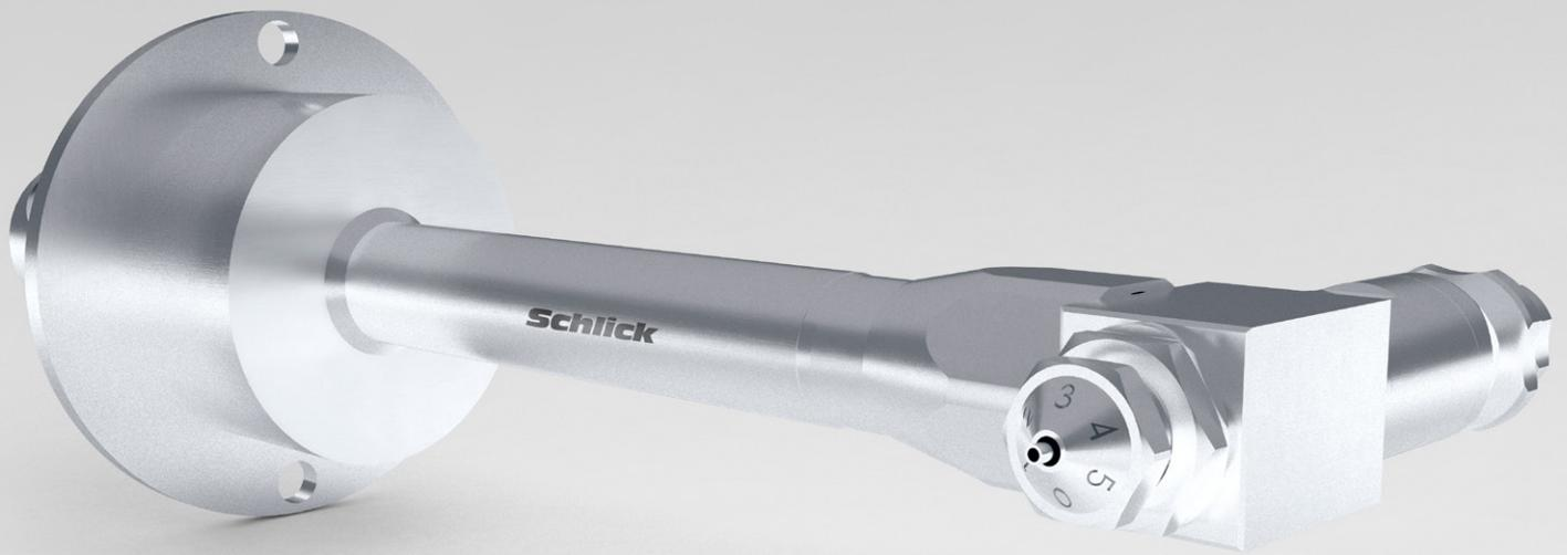
970系列喷嘴是高精度两流体喷嘴，风帽标有刻度，能精确调整雾化流量和角度，970系列喷嘴也是模块化产品，如有损坏，各部件都可以单独更换，也可通过更换部分部件改造成另外一种型号，并且雾化效果也能得到保证。喷嘴和喷杆就组成了制药行业专用喷枪，喷嘴和喷杆可选择螺纹、夹紧装置、螺钉等方式紧密连接，也可按客户要求的方式连接，喷杆长度可达2米以上。
