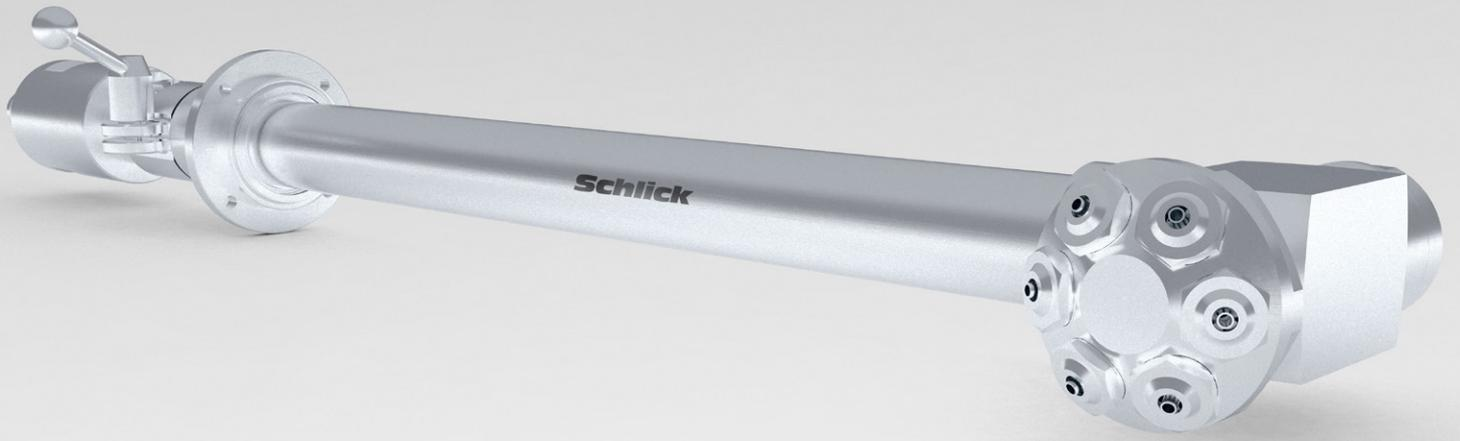
937系列喷嘴在获得最大雾化面积的同时，雾化极其均匀，针对客户不同应用，喷头可选择不同角度，常规937喷嘴有三个喷头和六个喷头两种，937喷嘴和喷杆就组成了制药行业专用喷枪，喷嘴和喷杆连接牢固、稳定，特别适用于大型流化床设备，Schlick这种连接可靠的专用喷枪显得尤为重要。
