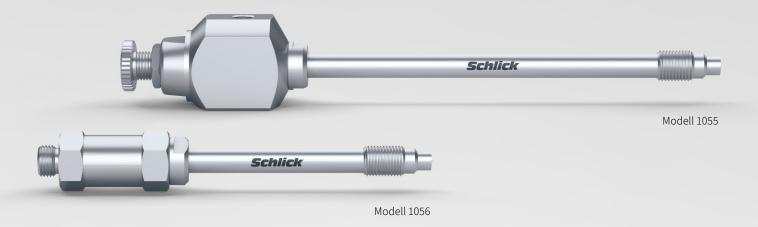
Der Öffnungsdruck ist von der Federstärke abhängig, die herstellerseitig auf Kundenwunsch festgelegt oder bei einzelnen Modellvarianten über eine Stellschraube eingestellt werden kann. Bei Düsenvarianten mit pneumatischer Auf-/Zusteuerung werden die sehr präzisen Öffnungs- und Verschlusszeiträume pneumatisch gesteuert. Je nach Modellvariante ist die Verwendung einer Reinigungsnadel möglich.
