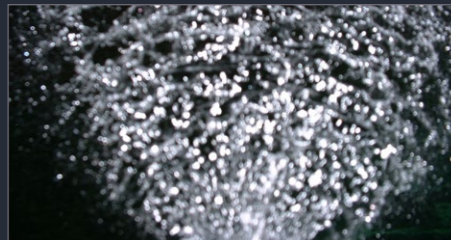
具有平流特性的压力喷嘴的雾化情况
