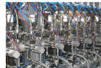
装配了SCHLICK喷胶装置的 板材生产线 Installation situation for the SCHLICK blowline
