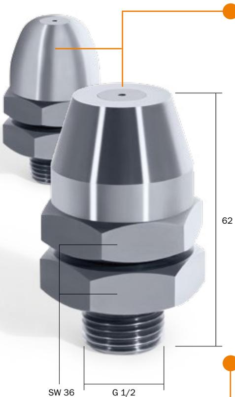
**SCHLICK Modell 432** mit Hartmetall-Standardausführung für die Zerstäubungstrocknung. Der Mündungseinsatz und Drallkörper sind aus Hartmetall gefertigt (geschliffen oder ungeschliffen). Durch zwei tangentielle Bohrungen in der Umlaufkammer ergeben sich besonders große Durchsätze.  $\varnothing$ -Bohrung: 0,5 – 6,0 mm (0,1 mm steigend). Auch als Sondervariante mit abgerundetem Oberteil zur Vermeidung von Ablagerungen erhältlich.
