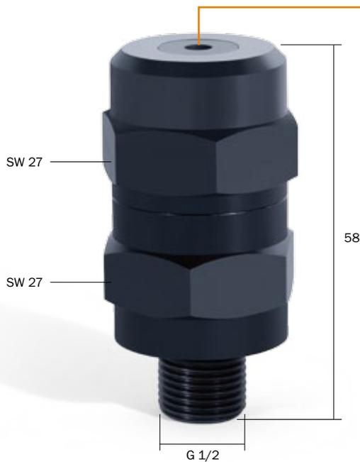
**SCHLICK Modell 118** mit Hartmetall für besonders feine Hohlkegelzerstäubung. Der Mündungseinsatz und Drallkörper sind aus Hartmetall gefertigt (geschliffen oder ungeschliffen). Durch Austausch des Mündungseinsatzes sind mit wenigen Handgriffen zahlreiche Variationen, auch im Streukegel möglich.  $\varnothing$ -Bohrung: 0,5 – 6,0 mm (0,1 mm steigend).
