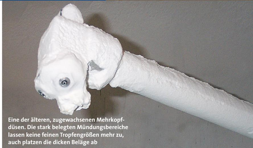
Eine der älteren, zugewachsenen Mehrkopfdüsen. Die stark belegten Mündungsbereiche lassen keine feinen Tropfengrößen mehr zu, auch platzen die dicken Beläge ab
