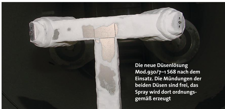
Die neue Düsenlösung Mod. 930/7-1 S68 nach dem Einsatz. Die Mündungen der beiden Düsen sind frei, das Spray wird dort ordnungsgemäß erzeugt
