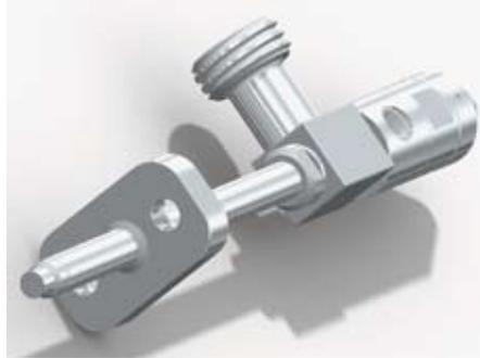
**Bei dieser Glattstrahldüse ist eine präzisionsgeschliffene Reinigungsnadel integriert, mit der die Austrittsbohrung der Düse zuverlässig freigeräumt wird; dies stellt eine saubere Bohrung sicher und gewährleistet damit eine genaue, stets gleich bleibende Dosierung**
